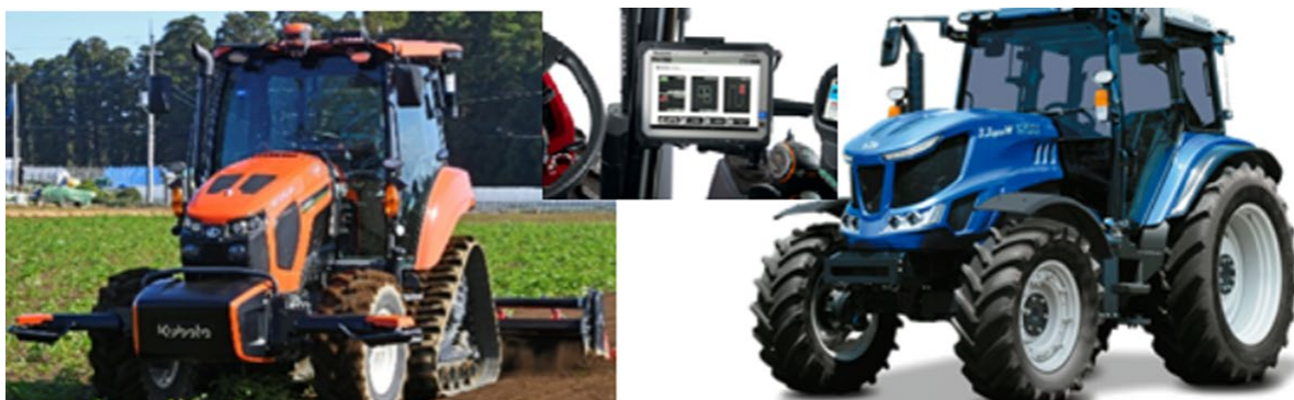
(図表2-1-19) 左から(株)クボタ、ヤンマーアグリジャパン(株)、井関農機(株)の自動操舵トラクターの画像
