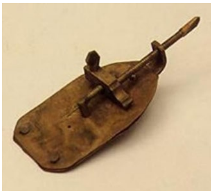
写真 5 アントニー・ファン・レーウエンフックの単式顕微鏡
