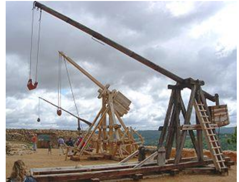
フランス・ペリゴール地方カステルノー城 (Castelnaud) に復元された平衡錘投石機
