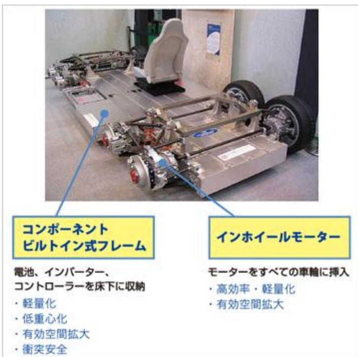
Platform by SIM-Drive は車輪の中と床下に設けられる強固なフレーム構造の中に走行に必要な主要部品の全てを収納する技術です。
